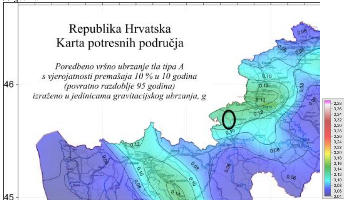
Slika 5: Izvod iz Karte potresnih područja u RH; Poredbeno vršno ubrzanje tla tipa A, povratno razdoblje 95 godina
